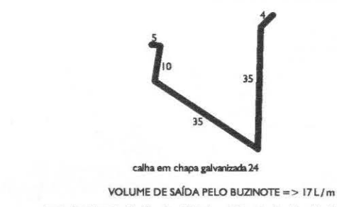
DETALHE CALHAS ESCALA 1:15
