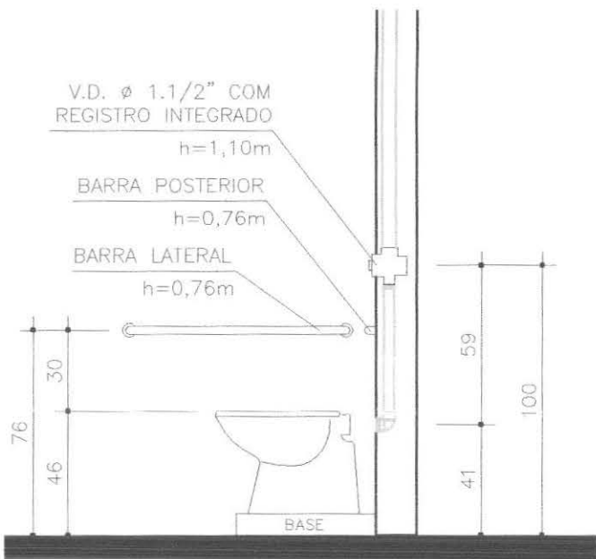
Detalhe Válvula de Descarga Escala 1/25
