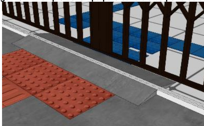
Imagem 9 – Exemplo de rampa para canaleta da porta de correr
