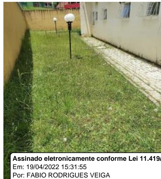
aparentemente, não existe sistema de drenagem no terreno, sendo essa a causa dos alagamentos.
