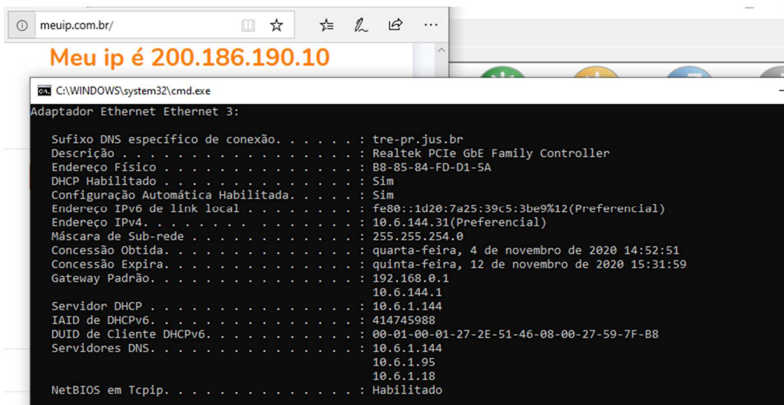
Figura 5: Tela do Sistema Operacional da máquina gerenciadora onde mostra o IP EXTERNO (200.186.190.10) e o IP INTERNO (10.6.144.31) que está conectada à internet através de conexão via celular
