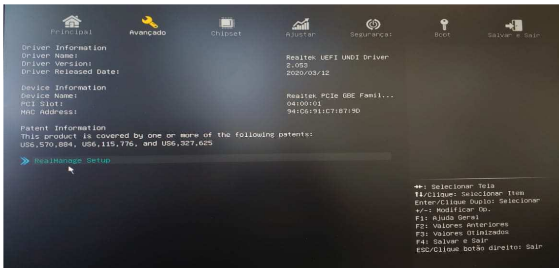
Figura 1: tela da Bios onde mostra o local de configuração de gerenciamento remoto OOB (out of band, ou rede fora da banda)
